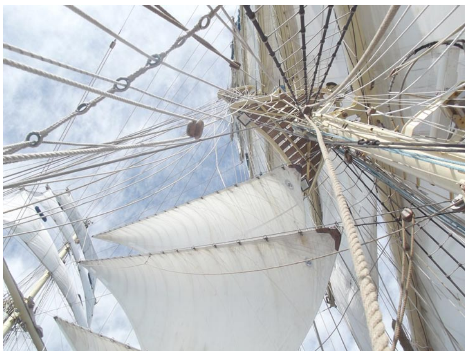
Fragment takielunku STS Fryderyk Chopin (widoczne grot- i fokmaszt oraz sztaksle), fot. Jacek Orzechowski
